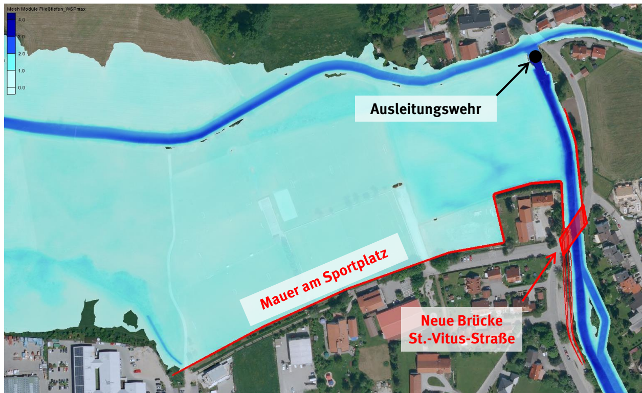
Abbildung 35: Verlauf der Flutmulde mit Fließtiefen HQ 100+K
